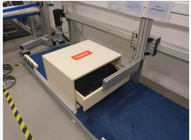
Res.4/Pic.4: Açma - Kapama Testi / Open - Close Test
