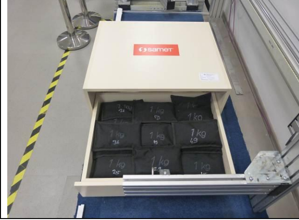
Res.1/Pic.1: Ray Açma - Kapama Dayanıklılık Testi 1 Rail Open - Close Durability Test 1
