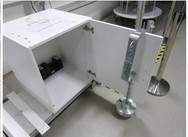
Res.4/Pic.4: Mentefe Dikey Statik Test Görünümü / Vertical Static Test View
